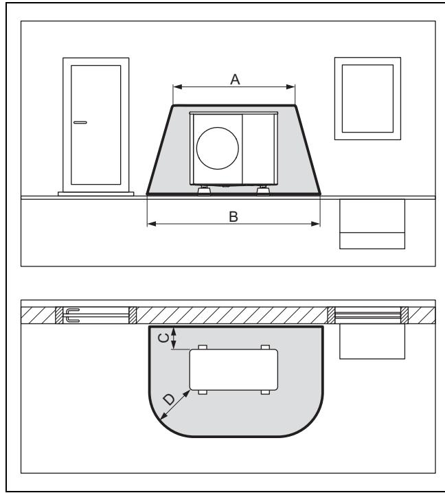
Målet C er min. afstanden til væggen, som skal overholdes
