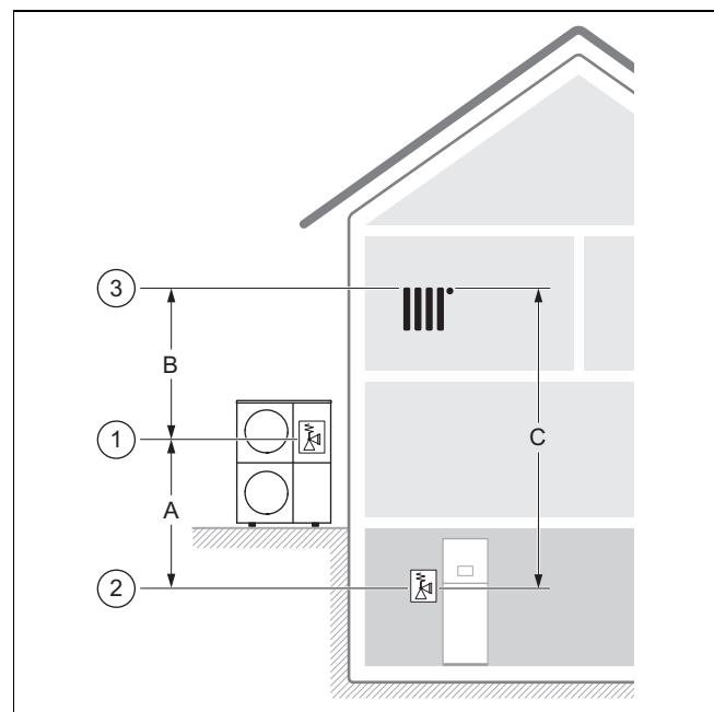
Ratkaisevaa on varoventtiilin sijainti (1) ulkoysikössä, varoventtiilin sijainti (2) lämmityspiirissä ja korkeimman kohdan sijainti (3) lämmityspiirissä.
