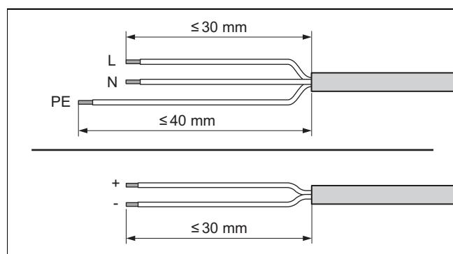
2. Afisolér den elektriske ledning som vist på illustrationen. Pas på ikke at beskadige de enkelte lederes isolering.
