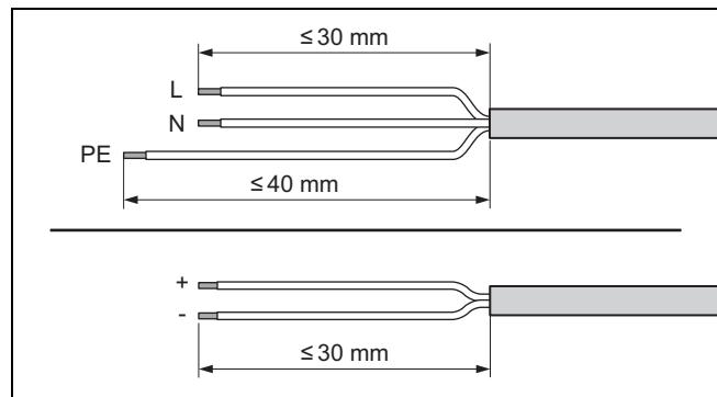
2. Avisolera den elektriska ledningen såsom visas på bilden. Var noga med att inte skada de enskilda ledarnas isoleringar.
