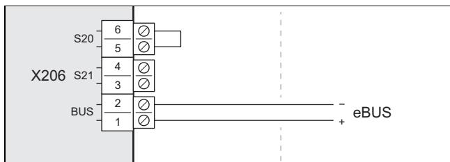
3. Anslut en eBUS-kabel på anslutningen X206, BUS.
