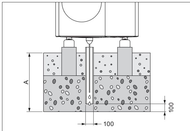
Mått A är för en region med markfrost  $\geq 900$  mm och för en region utan markfrost  $\geq 600$  mm.
