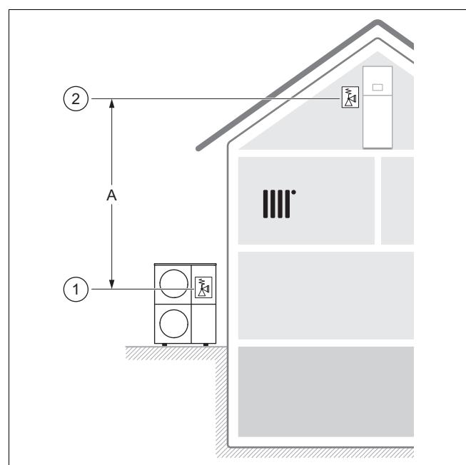
Ratkaisevaa on varoventtiilin sijainti (1) ulkoysikössä ja varoventtiilin sijainti (2) lämmityspiirissä.
