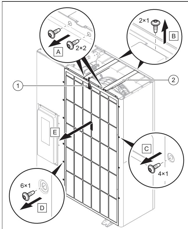
1. Irrota lämpötila-anturin (1) sähköliitintä.
