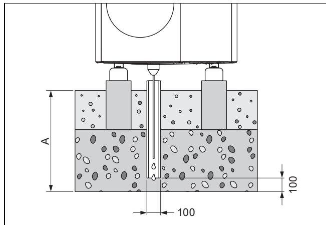
Målet A udgør et område med jordfrost  $\geq 900$  mm og et område uden jordfrost  $\geq 600$  mm.
