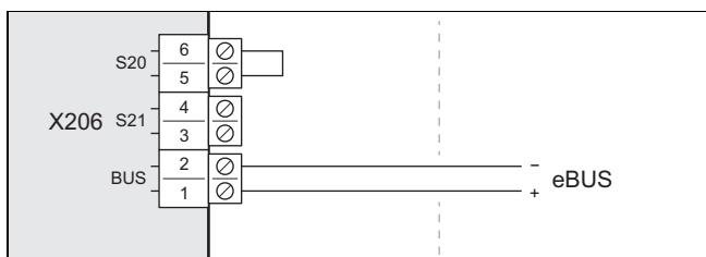
3. Koble til eBUS-ledningen på koblingen X206, BUS.
