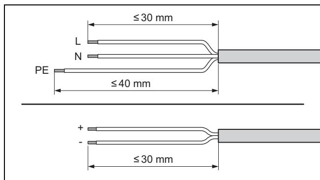
2. Avmantle den elektriske ledningen som vist på illustrasjonen. Pass på at isolasjonen til de enkelte ledene ikke skades.
